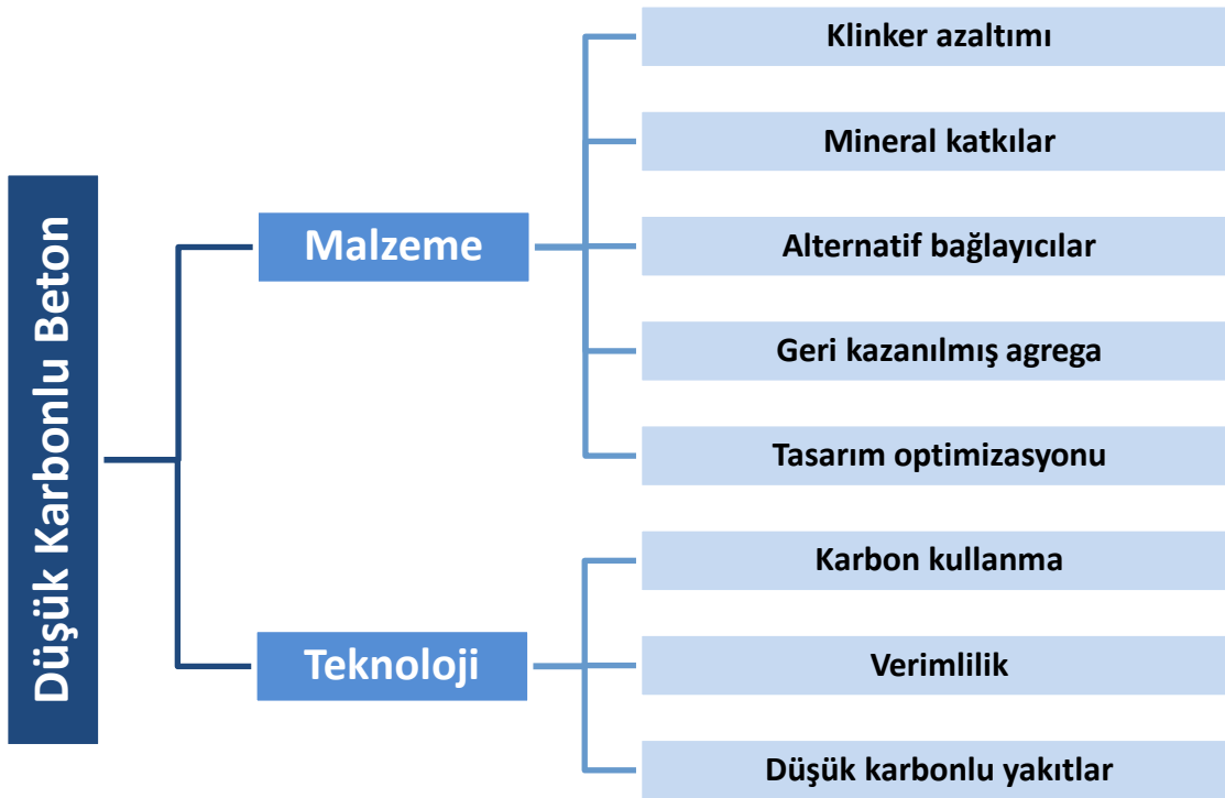
Şekil 13. Düşük karbonlu beton üretimi için bazı yöntemler
