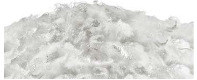
Plastik betonun büzülme çatlamaını kontrol etmek için kullanılan mikro fiber takviyesi
