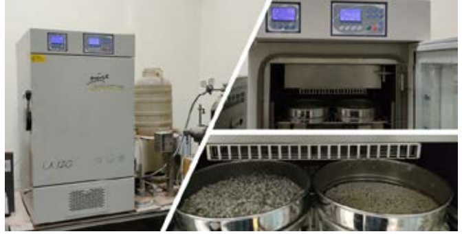
Şekil 1. İYA-esaslı malzemelere uygulanan karbonatlaşma işlemi
