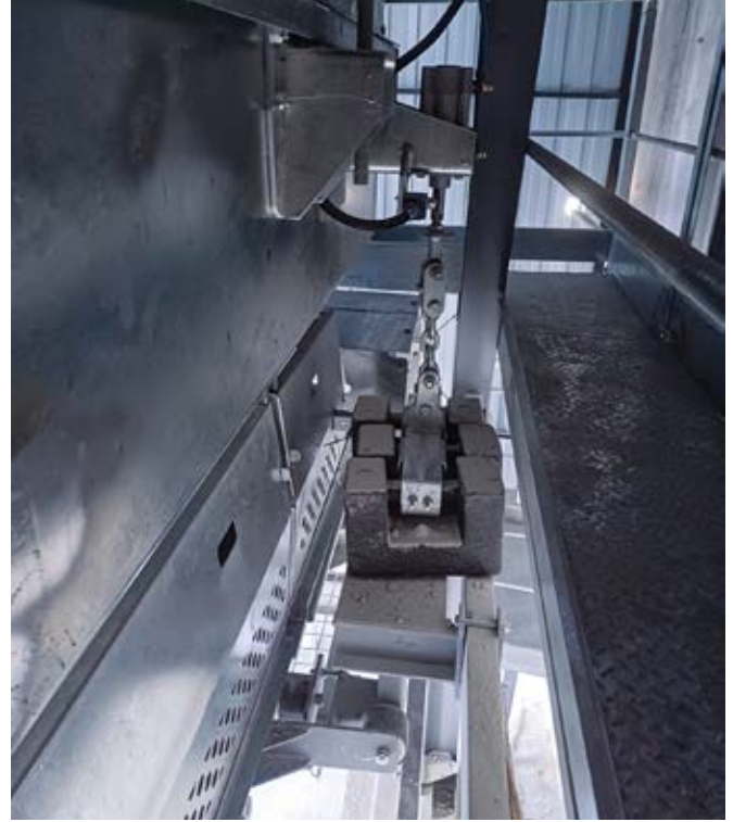
MEKA Agregatartım bunkerleri için otomatik kalibrasyon sistemi
