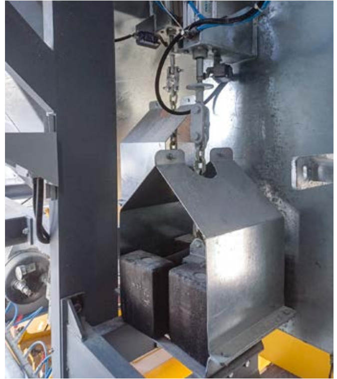
MEKA Çimento ve Su tartım bunkerleri için Otomatik Kalibrasyon Sistemi
