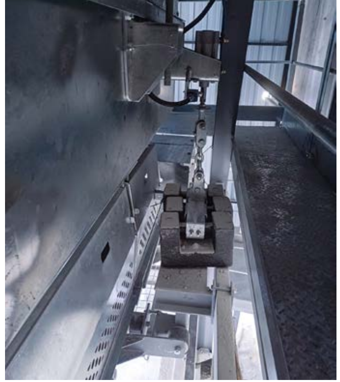
MEKA Agregatartım bunkerleri için otomatik kalibrasyon sistemi
